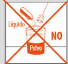
**3** Abrir el balde Kit Base Polimérica Microfloor, retirar el bidón de 5 L (Resina Acuosa Base). Para la mezcla se debe evitar la formación de grumos. Para ello primero se deberá verter la emulsión acrílica en un balde vacío y limpio, luego esparcir el Polvo Kit Base Microfloor® en forma de lluvia y al mismo tiempo mezclar con el batidor, hasta lograr un producto homogéneo, cremoso y sin grumos (\*\*\*)
