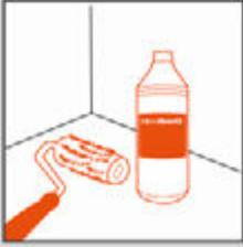
**1** Aplicar con rodillo de lana, Microfloor® Puente de Adherencia sobre la superficie existente.
