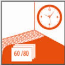
**4** Aplicar con llana metálica, la primer mano de la mezcla sobre la malla. Dejar secar y lijar (usar lija al agua de 60/80 o fratacho de goma espuma) para obtener una terminación lisa y sin irregularidades.
